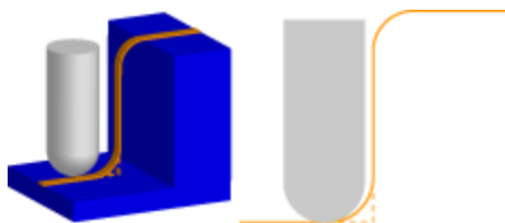
Příklad dráhy nástroje s aktivovaným (1) a deaktivovaným (2) Tečným Rozšířením .
